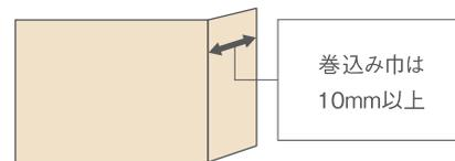
巻込み巾が10~30mmの場合は、強力目地用接着剤「メジ・ピタ」を使用してください。
