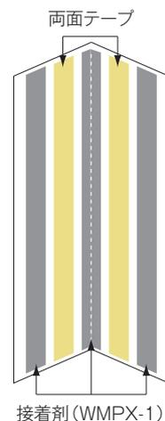
**注意** 重ね貼りでも充分な接着強度がありますが、過度の力が加わると、リアルデコごと剥がれてくる可能性があります。そのような状況があらかじめ想定される場合には、接着剤「WMPX-1」を併用し、リアルデココーナー材を下地に直接貼付けてください。リアルデコがすでに施工されている場合は、リアルデココーナー材を施工する部分の出隅から1.5cmまでの壁紙を、裏紙まで全て剥がしきり下地面を完全に露出させてから適切な下地処理を行い、「WMPX-1」を併用して貼付けてください。
