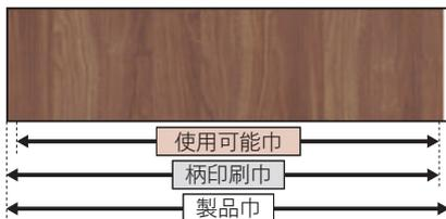
(条件) リアルデコの柄印刷巾(約940mm)のうち、運搬等で端部が傷んだ場合を想定して、935mmを使用可能な最大巾としています(通常施工時の有効巾は920mmです)。
